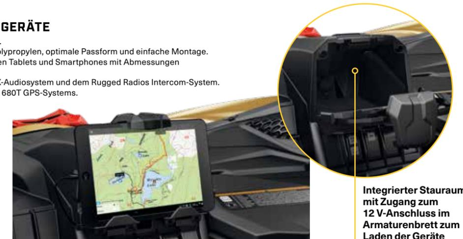
**Integrierter Stauraum mit Zugang zum 12 V-Anschluss im Armaturenbrett zum Laden der Geräte**
