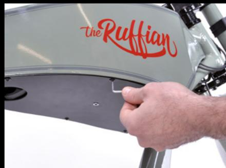
Die Stahlplatte und der Akku lassen sich schnell und einfach entfernen
